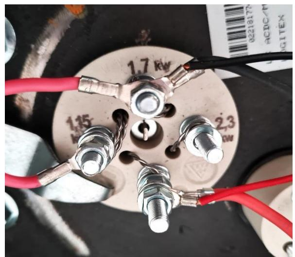
**Zapojenie TPK 150 (2x1,15kW)**
