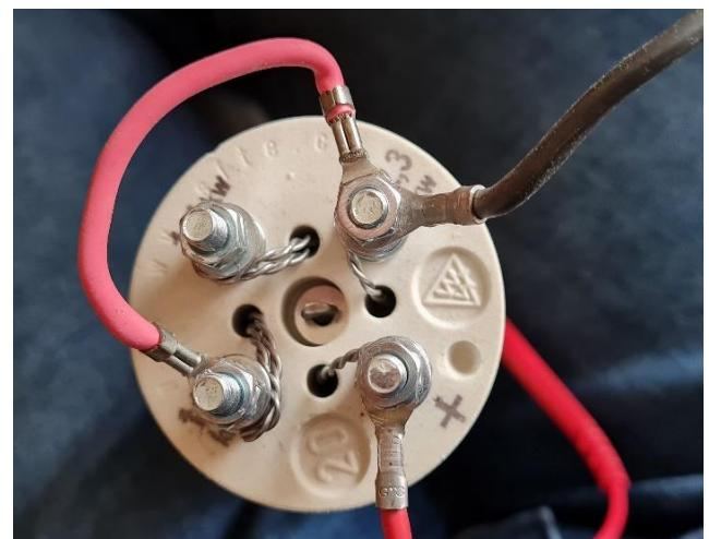
**Zapojenie DC špirály podľa počtu FV panelov a výkonu FV panelov**
